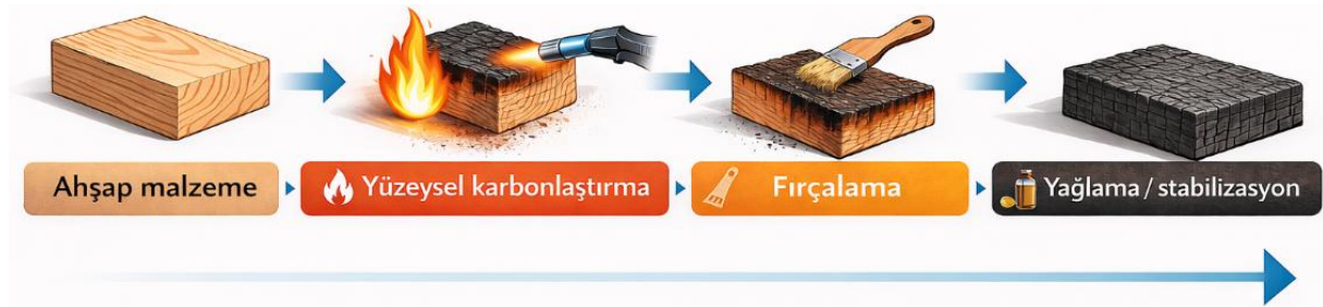
Şekil 2. Yüzeysel karbonlaştırma uygulama sürecinin temel aşamalarını gösteren şematik akış diyagramı.
