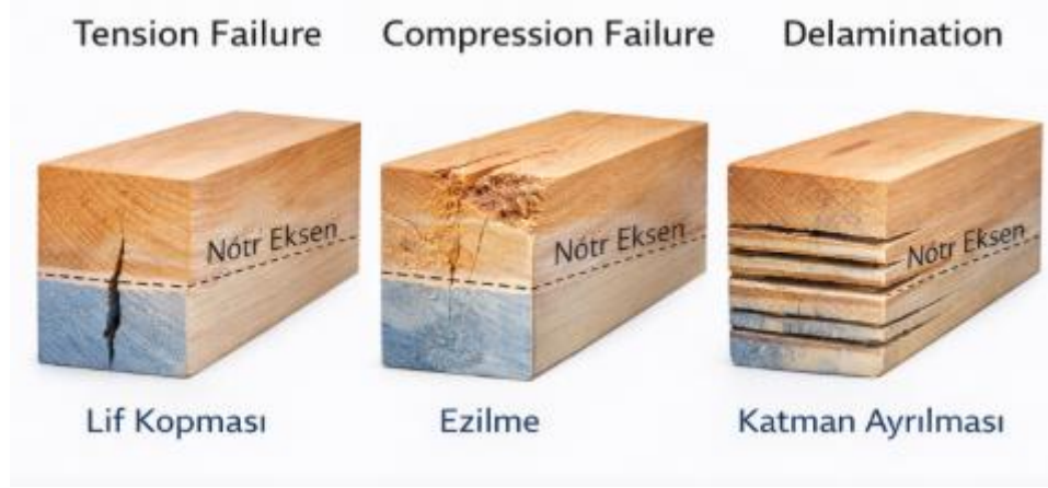
Şekil 5. Lamine ahşap kirişlerde tipik hasar mekanizmalarının (lif kopması, ezilme ve katman ayrılması) görsel gösterimi
